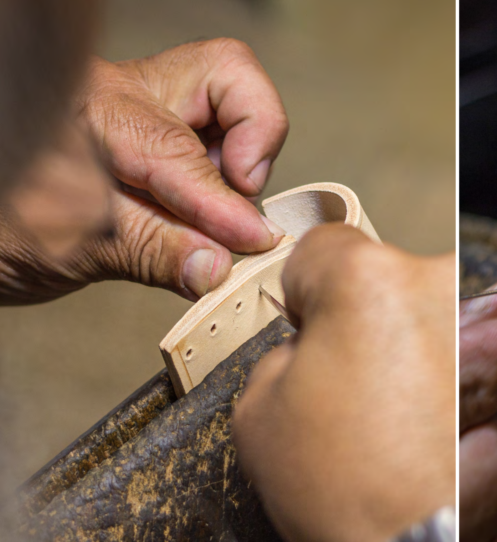
Vergrößern der Löcher mit einer Ahle - eingespannt im Nähkloben
