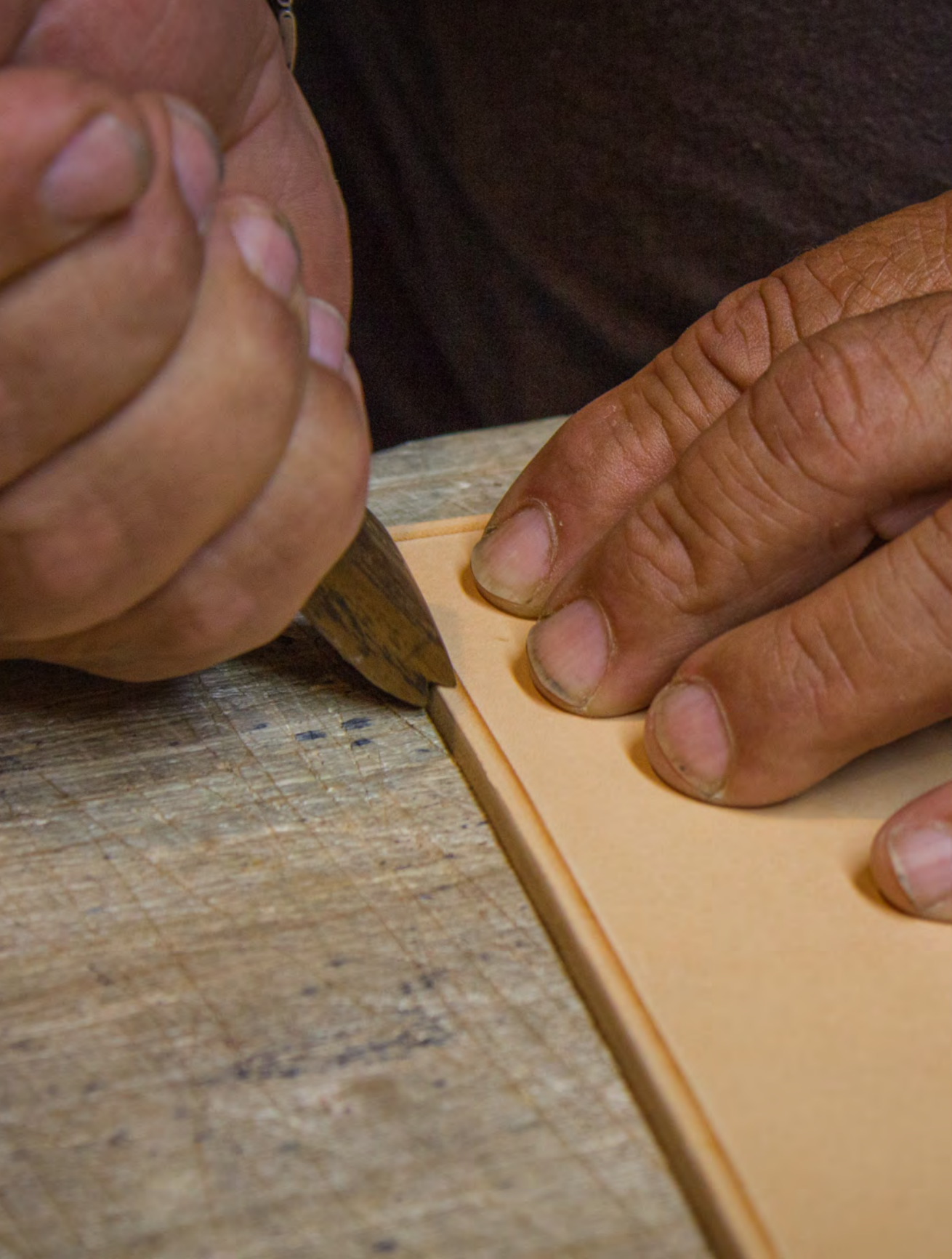
Kantenverzierung mit dem Nachtversenker
