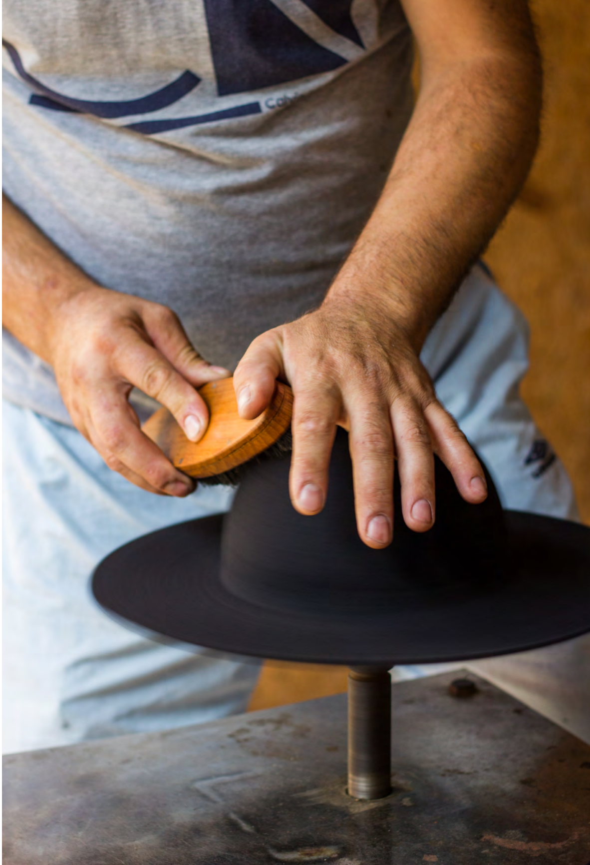
Bürsten und Polieren der Hüte an selbstgebauter Rotationsmaschine
