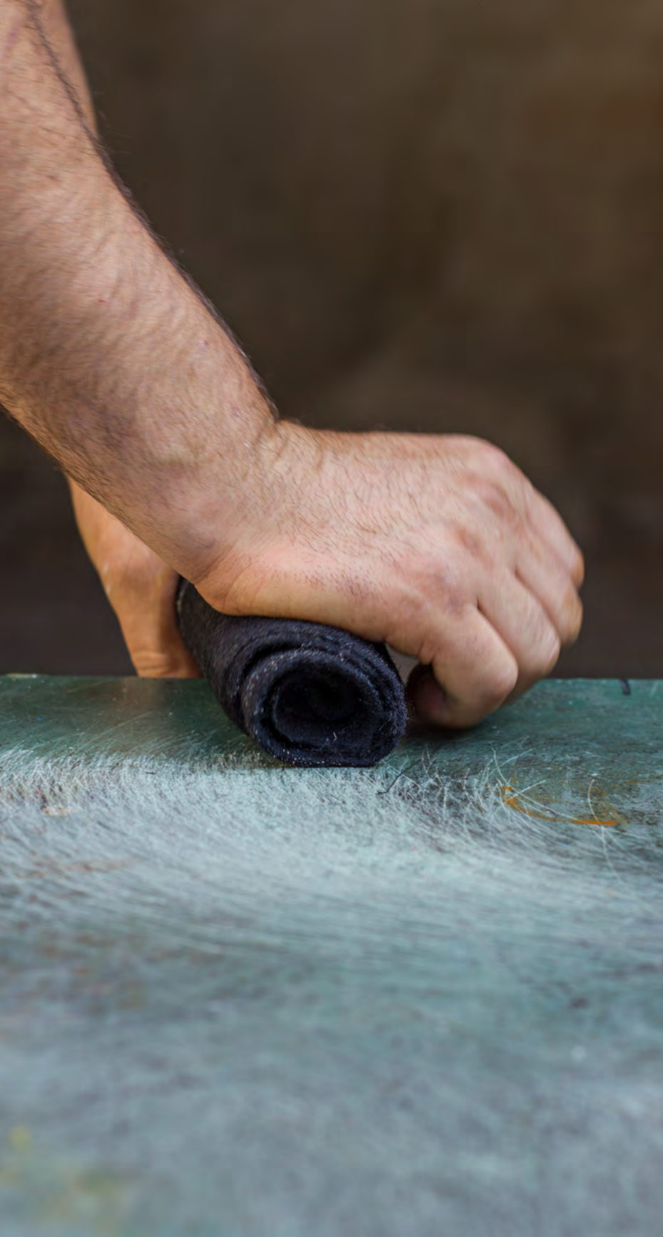
Auswalzen der Filzrohlinge, um die bereits aufgetragene eSolution besser zu verteilen
