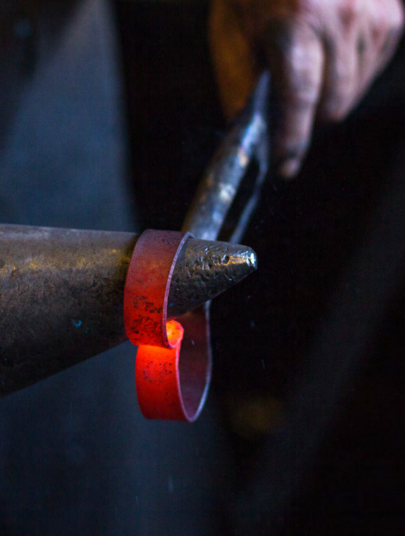
Simpler Federmechanismus der Wollschere
